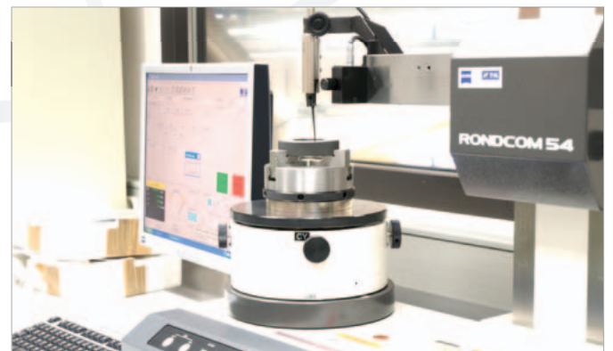
Messung der Formtoleranzen an Einstellringen Measuring of form tolerances on adjusting rings
