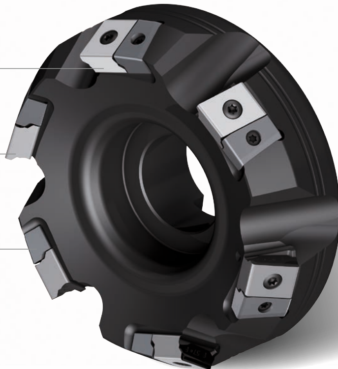
Schwerzerspaner M3016 Ø 160 mm, \kappa = 60^\circ mit Systemwendeplatte LNMX201012...
