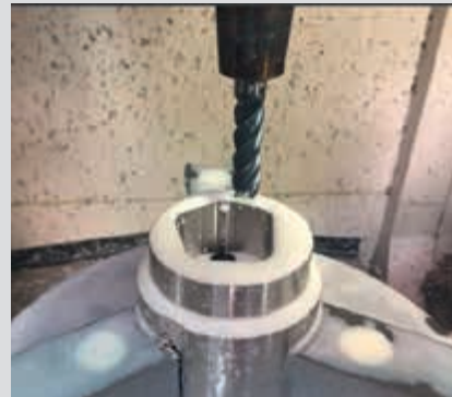
Walter Sonderwerkzeug: Neues Spanteiler-Design bildet kurze Späne, die den Spanabtransport erleichtern.
