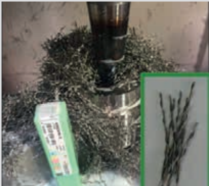
Standardwerkzeug: Lange, glatte Schneiden führen zu langen Spänen welche Spänenester erzeugen.
