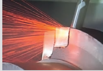
Keramik-Fräser im Einsatz: Blink-Bearbeitung (Plungen), Inconel
