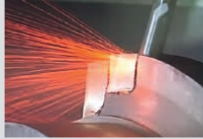
Keramik-Fräser im Einsatz: Blick-Bearbeitung (Plungen), Inconel
