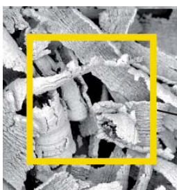
Durch das Fräsen entstandene Späne - Größe ca. 5 bis 8 µm Chips caused by milling - size approx. 5 - 8 µm
