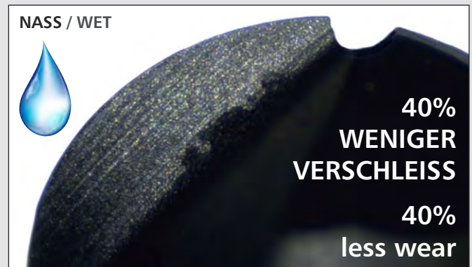
NASS GEFRÄST, Fräszeit 490 Minuten WET MILLED, after 490 minutes of milling
