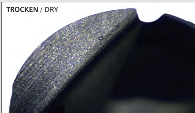
TROCKEN GEFRÄST, Fräszeit 490 Minuten DRY MILLED, after 490 minutes of milling
